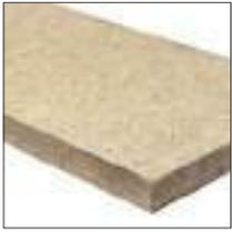
Rivestimento interno in vermiculite.
