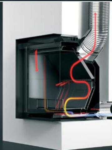
Raccordo uscita fumi verticale o inclinato, quest'ultimo particolarmente utile in caso di condotti distanti. Presa d'aria esterna inferiore o posteriore (optional)
