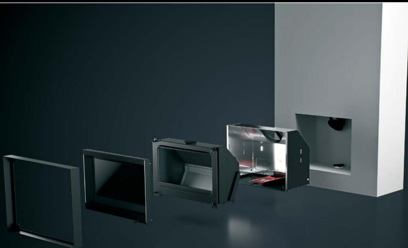
Grazie al suo box di pre-posa, Stûv 6-in si installa molto facilmente in qualsiasi tipologia di caminetto. Questo box facilita il collegamento dell'inserto al condotto fumario e alla presa d'aria esterna. Una volta fissati i vari collegamenti, l'inserto viene fatto scorrere e posizionato ermeticamente all'interno del box di pre-posa.
