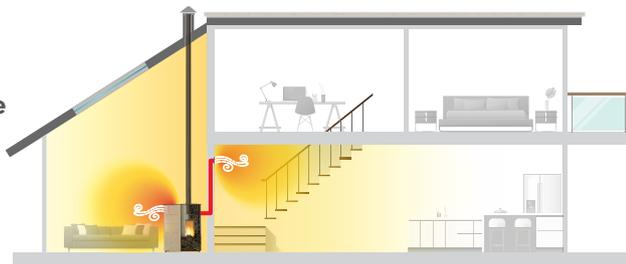
I modelli dotati di Twin Air System aggiungono alla funzione dell'aria ventilata la possibilità di deviare il flusso dell'aria calda in un secondo ambiente (fino a 8 m di canalizzazione lineare), ideale per scaldare due ambienti adiacenti.
