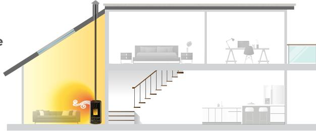
Le stufe Ecofire® ad aria ventilata sono dotate di un ventilatore che diffonde l'aria calda prodotta dalla combustione rapidamente in tutto l'ambiente. Grazie al controllo elettronico è possibile gestire la potenza della stufa e la velocità del ventilatore in base alle personali esigenze di calore.
